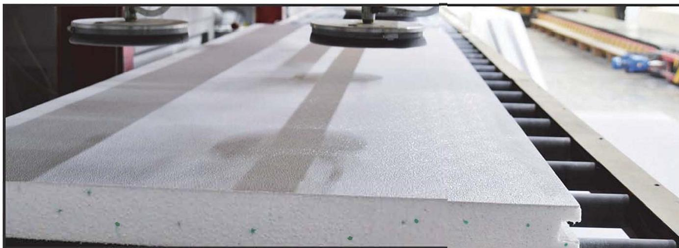
Élément sandwich - composé d'un noyau en polystyrène avec des couches de revêtement sur les deux faces.
