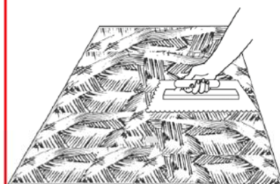
Appliquez l'adhésif jusqu'au bord du panneau en tenant le couteau à 45°.
