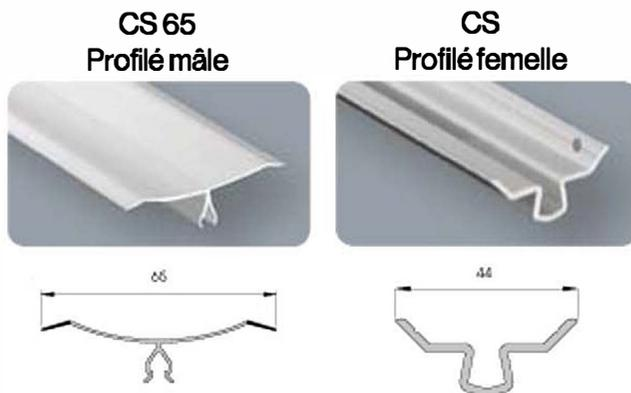
Solution de finition pour arrondir les angles mur - mur et / ou mur - plafond tout en garantissant l'hygiène des locaux et facilitant le nettoyage. Lèvres souples pour une meilleure étanchéité.
